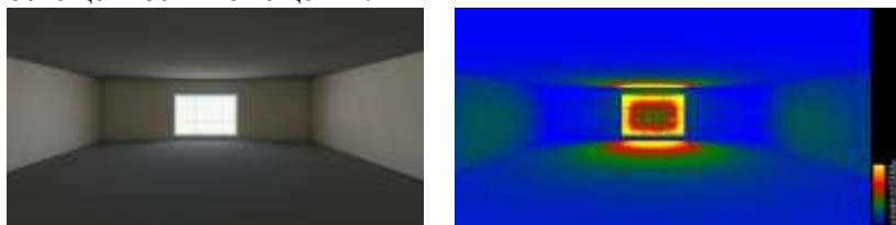
Рисунок 1 - Анализ освещения комнаты с одним окном с обычным стеклом.
