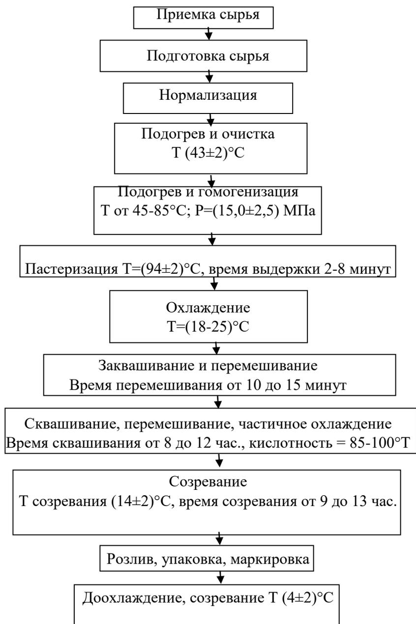
Рисунок 1 – Технологическая блок-схема приготовления кефира резервуарным способом
