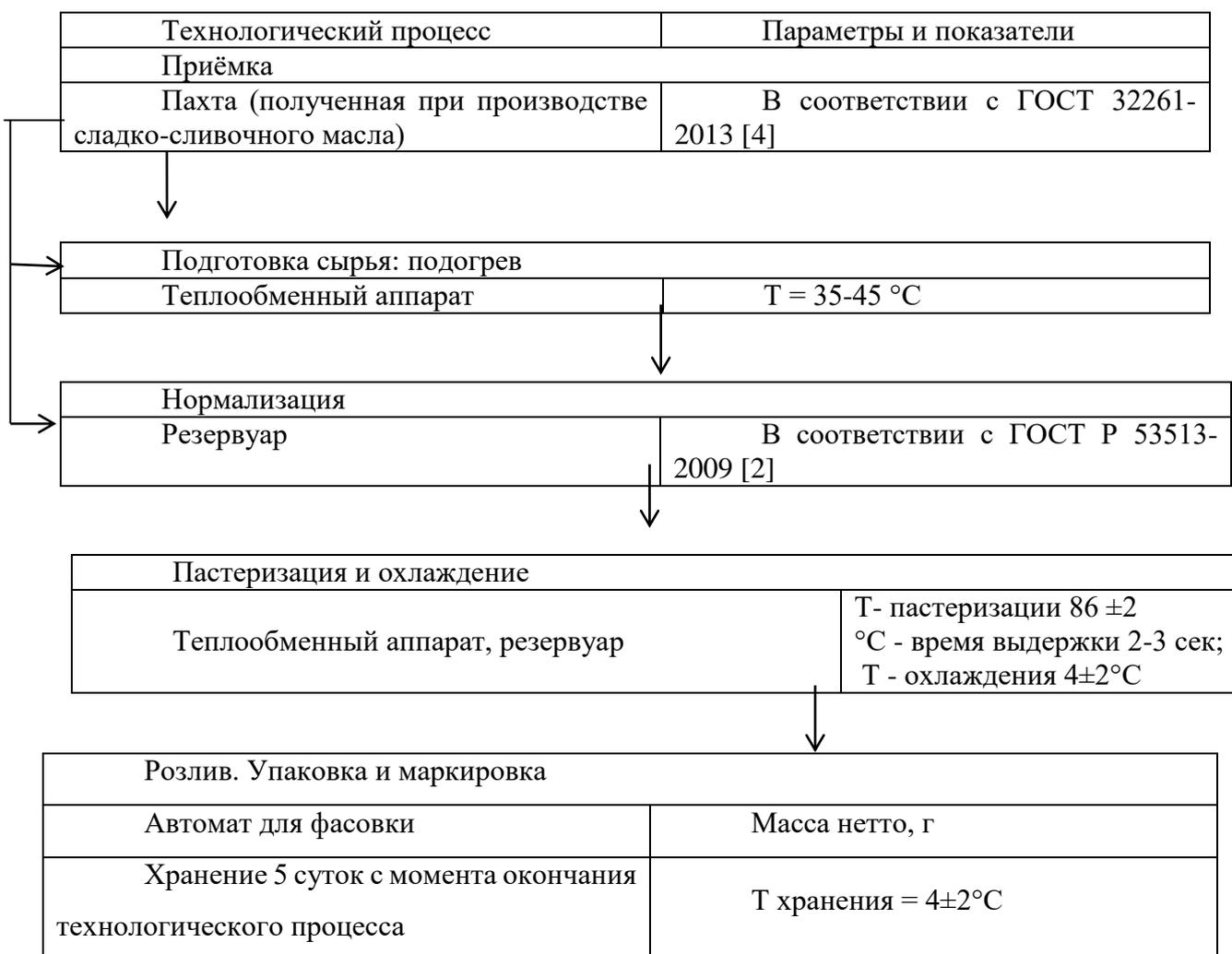
Рисунок 2 – Технологическая схема производства пахты пастеризованной
