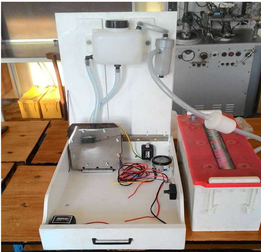
Рисунок 3 – Экспериментальная установка для производства ННО-газа
