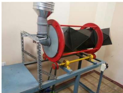
Рисунок 1 – Устройство для непрерывного приготовления кормов (вид со стороны загрузки)
