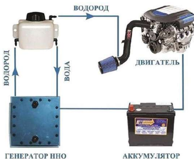
Рисунок 2 – Упрощенная схема подключения генератора и вспомогательного оборудования для производства ННО-газа к гибридной силовой установке
