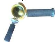
Ячеисто-дисковый высевающий аппарат
