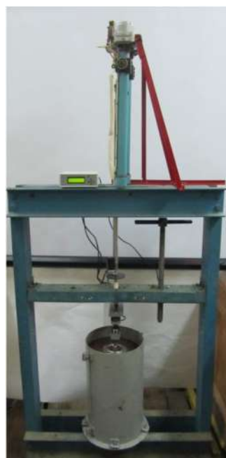
Рисунок 1 – Схема зондирования и опытная установка стержневой штамп «ПСД»
