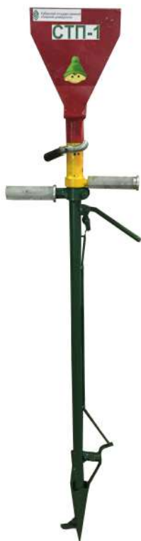
Сеялка СТОП-1 для посева пропашных культур, чеснока и лука с полуавтоматическим приводом высевающего диска
