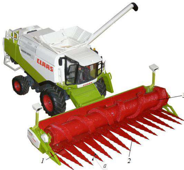
Рисунок 3 – Модернизация жатки Vario 900 к комбайну Lexion 620:
