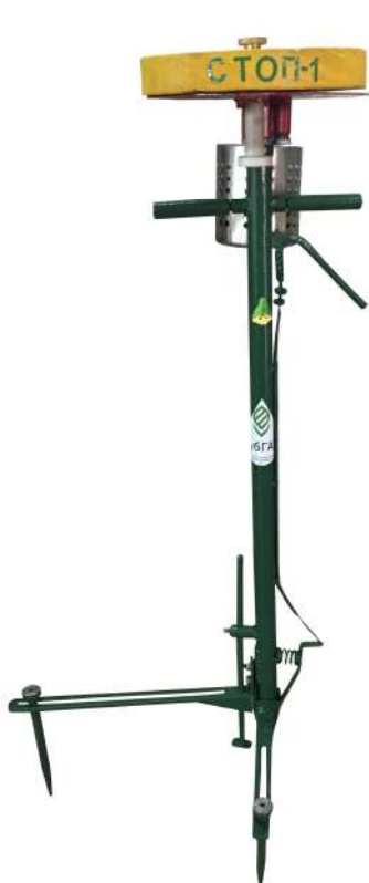
Сеялка СТОП-1 для посева пропашных культур, чеснока и лука с полуавтоматическим приводом высевающего диска
