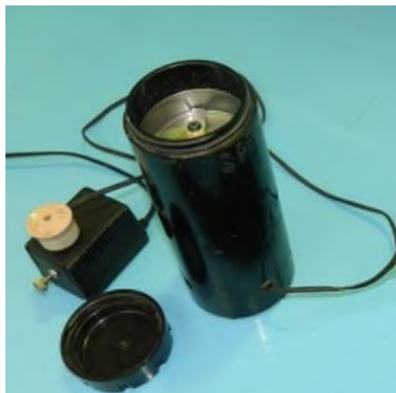
Рисунок 2 – Общий вид первого варианта устройства для обмолота бобов люцерны на этапе селекции
