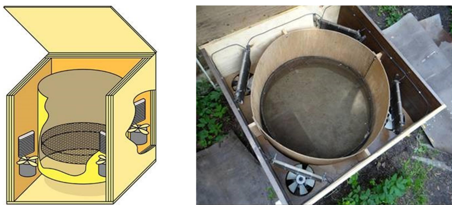
Рисунок 1.2 – Изображение и фотография одного из вариантов тепловой камеры для пчел, используемой в борьбе с клещом варроа [11]
