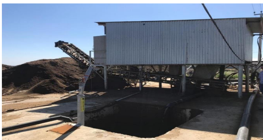
Рисунок 4.5 – Выполнение процесса сепарации на станции SB-780 для получения жф и тф
