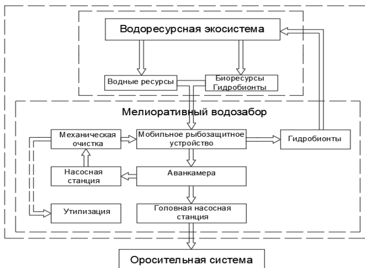
Рисунок 4 – Принципиальная схема водоресурсной экосистемы: мелиоративный водозабор – мобильная рыбозащита
