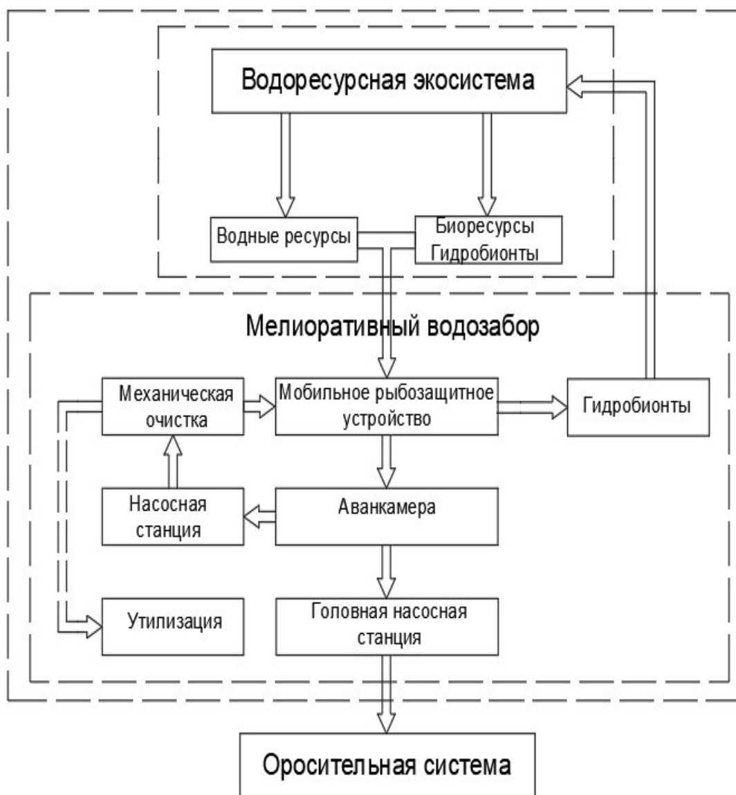
Рисунок 2.15 – Принципиальная схема водоресурсной экосистемы: мелиоративный водозабор – мобильная рыбозащита
