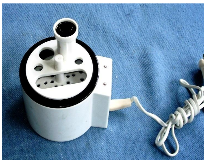
Рисунок 51 – Биологические термостаты для разморозки соломинок и гранул
