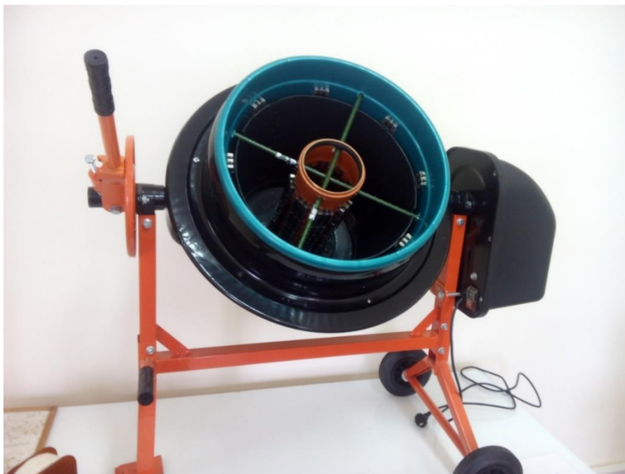
Рисунок 3.3 – Внешний вид экспериментальной установки для исследования параметров и режимов магнитной установки с постоянными неодимовыми магнитами
