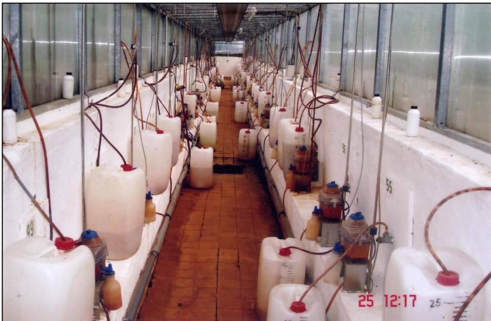
Рис. 17. Подземный коридор лизиметров в Паулиненгауе, где помещены приемники стекающей влаги
