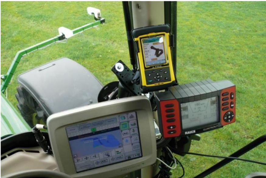
Рис. 51. Навигационная система для дифференцированного внесения удобрений
