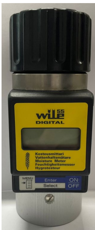
Рисунок 3.6 – Общий вид влагомера Wile 55
