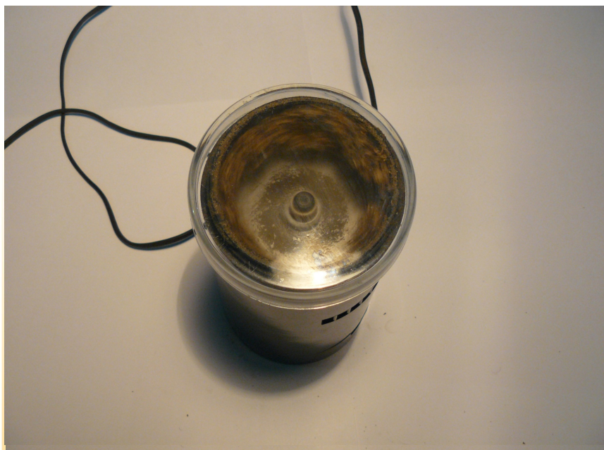
Рисунок 3.7 – Обмолот в псевдоожиге циркулирующем замкнутом потоке
