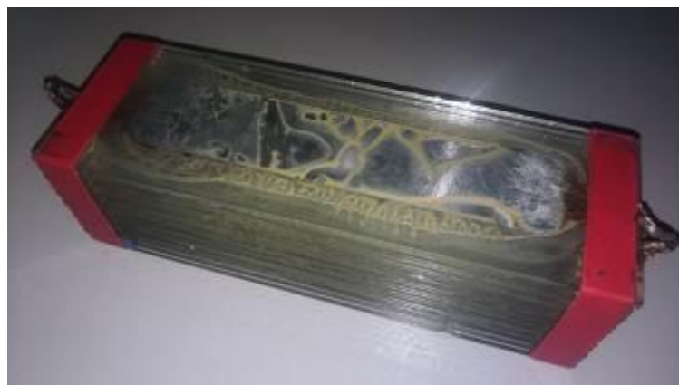
Рисунок 1.11 – Фотография разрядного устройства озонатора пластинчатого типа используемого в озонаторах для пчеловодства
