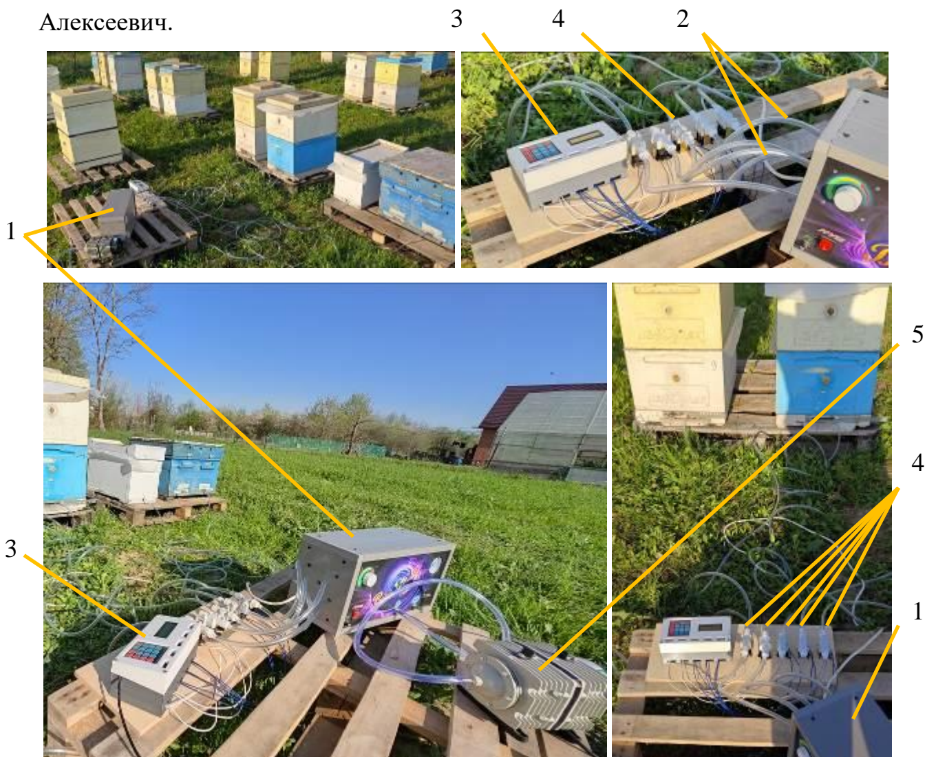
1 – озонатор; 2 – воздуховоды; 3 – устройство автоматизированного управления подачей озона в улья; 4 – электромагнитные клапаны; 5 - компрессор
