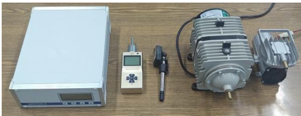
Рисунок 3.2 – Фотография используемого оборудования, слева на право: измерители концентрации озона Циклон-5.41 и XLA-BX-O3, анемометр Testo-405, компрессоры АСО-009D (125 л/мин) и АСQ-903 (70 л/мин).
