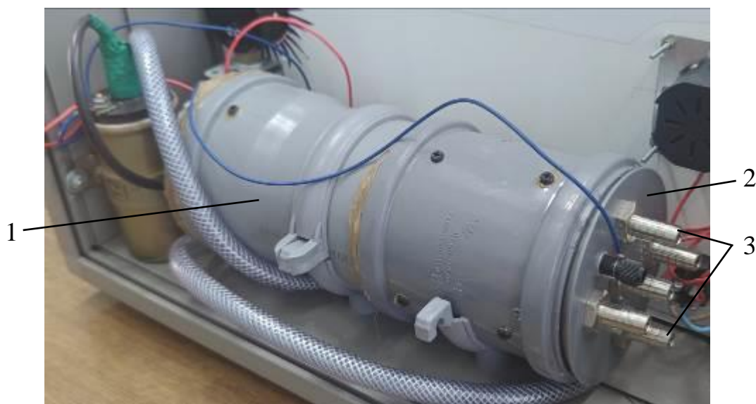
1 – корпус озонатора; 2 – выходной блок озонатора; 3 – патрубки для подключения воздуховодов
