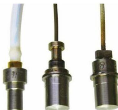
Рисунок 2 – Пьезоэлектрические датчики давления
