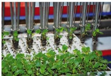
Рисунок 1 – Пикировка рассады с помощью пальцев-захватов на пикировочной машине Urbinati
