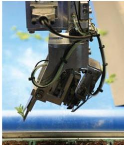
Рисунок 2 – Робот для посадки и пикировки рассады Denso Denso (Япония).
