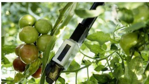
Рисунок 3 – Удаление листьев томата с помощью агро-робота Kompano Deleaf-Life (Голландия)
