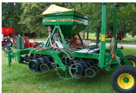
Рисунок 2 – Пневматическая сеялка John Deere 750 А, предназначенная для посева зерновых культур по минимальной и нулевой технологиям обработки
