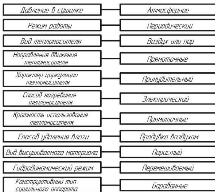
Рисунок 2– Конструктивно-технологические параметры и режимы работы
