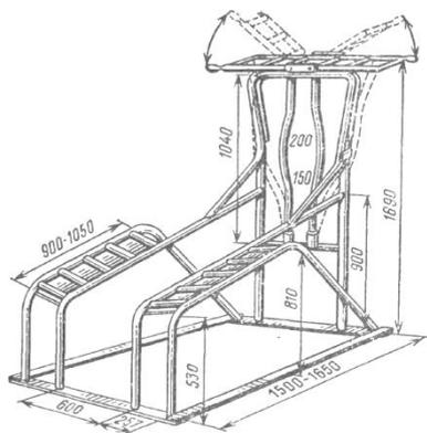
**Рис.** Взятие спермы у быка на механический станок
