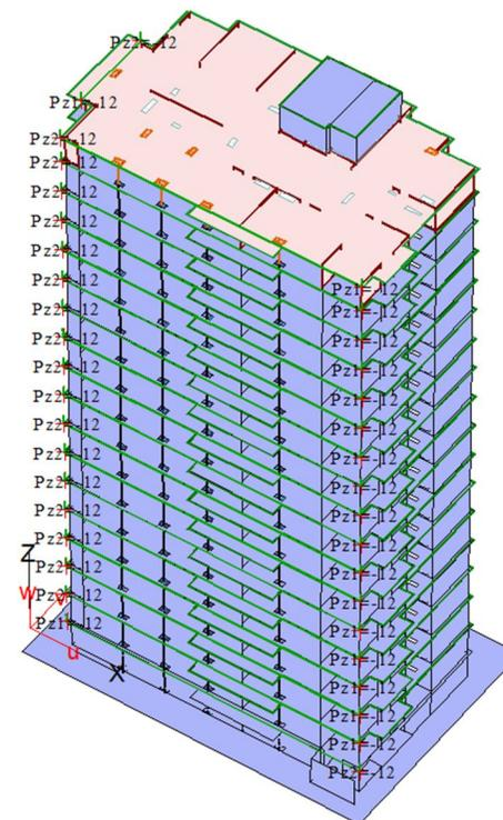
Рисунок 2.66 – Заданная ветровая нагрузка на каркас здания
