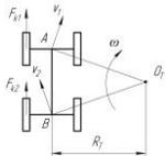
Рисунок 1 – Бортовой способ поворота колёсного трактора
