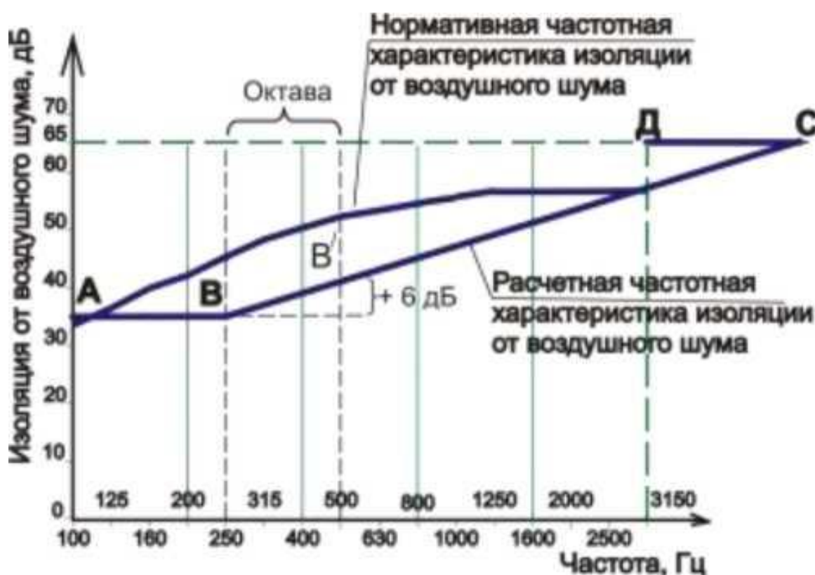
Рисунок 1 - Схема к расчету звукоизоляции перегородки
