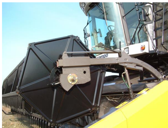
Рисунок 9.6 – Пальцы мотовила
