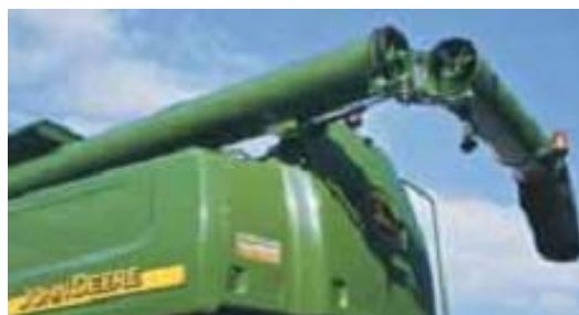
Рисунок 7.8 – Выгрузной шнек
