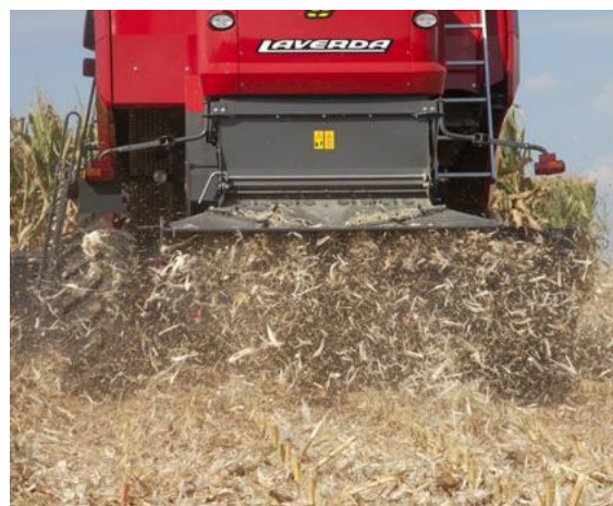
Рисунок 11.11 – Измельчитель
