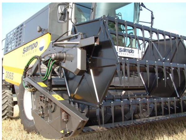
Рисунок 9.6 – Пальцы мотовила
