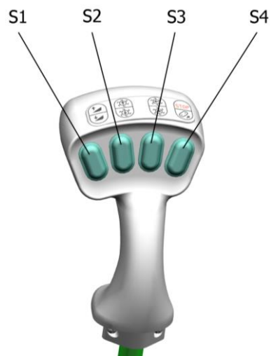
Рисунок 5.15 – Клавиши рукоятки рычага управления движением:
