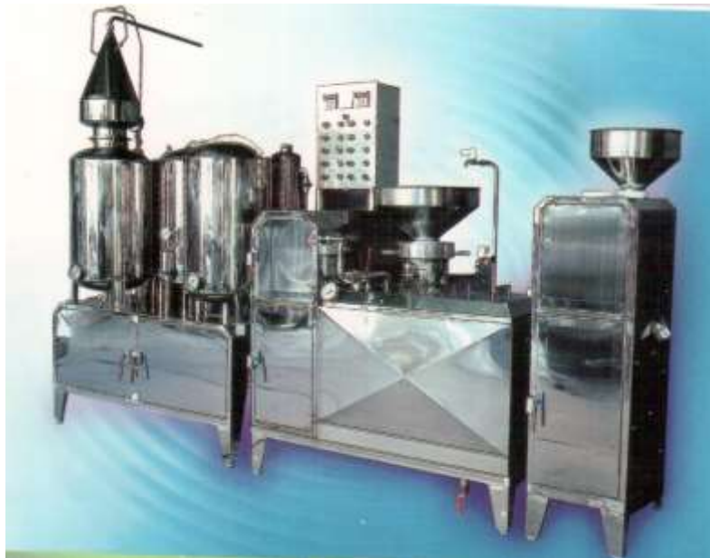
Рисунок 1.13 – Общий вид миникомбината по приготовлению соевого «молока», разработанного и выпускаемого компанией CHUNGHA INTERNATIONAL Co., Ltd (КНР)
