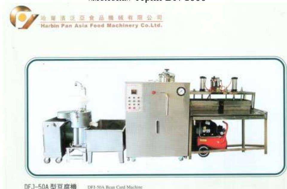
Рисунок 1.12 – Общий вид агрегата серии DFJ-50A с установленной мощностью 20 кВт и производительностью 50 кг/ч
