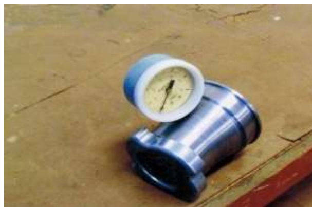
Рисунок 26П – К обоснованию давления в компрессионной камере пресс-гранулятора
