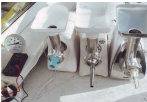
Рисунок 3.3 – Общий вид экспериментального оборудования по изучению процесса получения гранулированных и брикетированных продуктов с различными типами сопла
