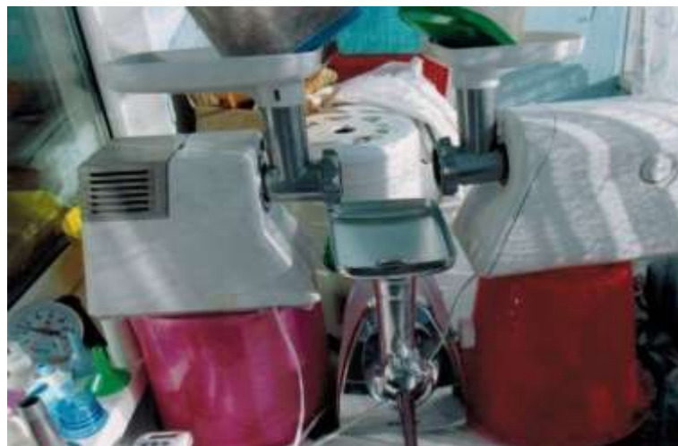
Рисунок 19П – Общий вид лабораторной установки для получения гранул на основе соево-корнеплодных и корнеплодно-зерновых композиций
