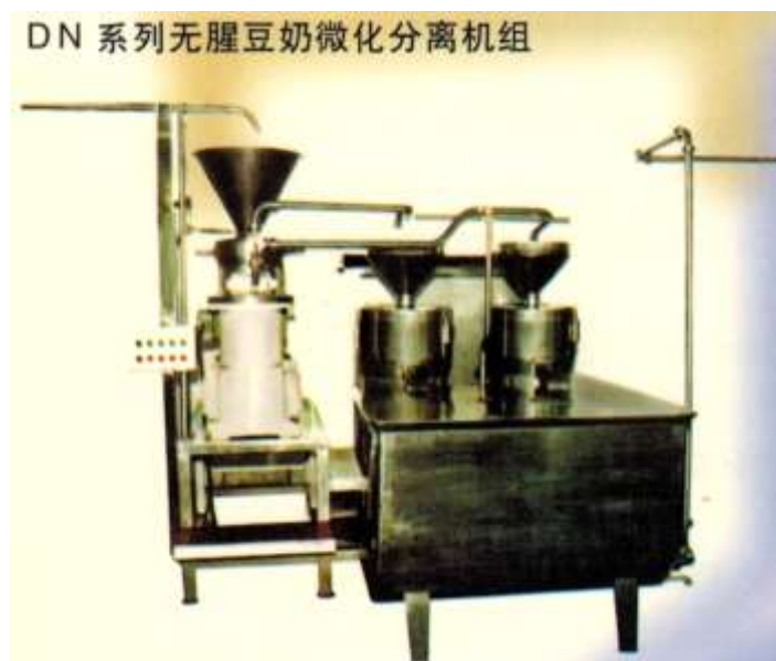
Рисунок 1.10 – Общий вид установки для производства соевого «молока» серии DN40
