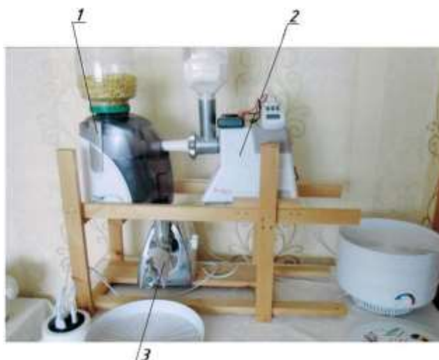
1 – дезинтеграционно-экстракционное устройство для измельчения композиции и получения ЗЦМ (ДЭУ); 2 – дозатор; 3 – гранулятор жомового остатка
