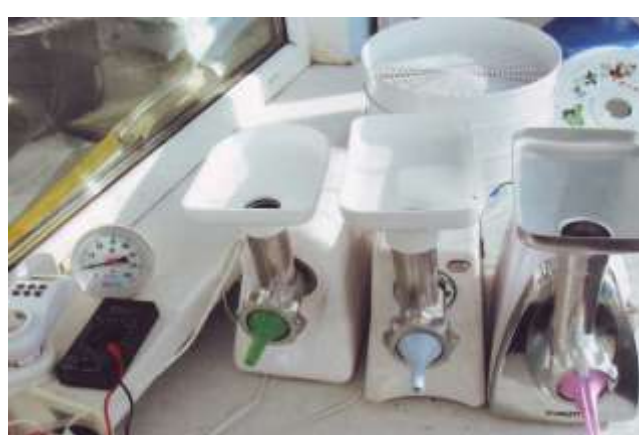
Рисунок 3.3 – Общий вид экспериментального оборудования по изучению процесса получения гранулированных и брикетированных продуктов с различными типами сопла
