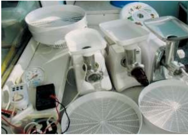
Рисунок 20П – Общий вид лабораторного комплекса для получения брикетов с продольным каналом
