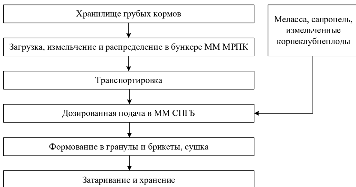
Рисунок 4.6 – Технологическая схема подготовки и приготовления формованных кормовых продуктов
