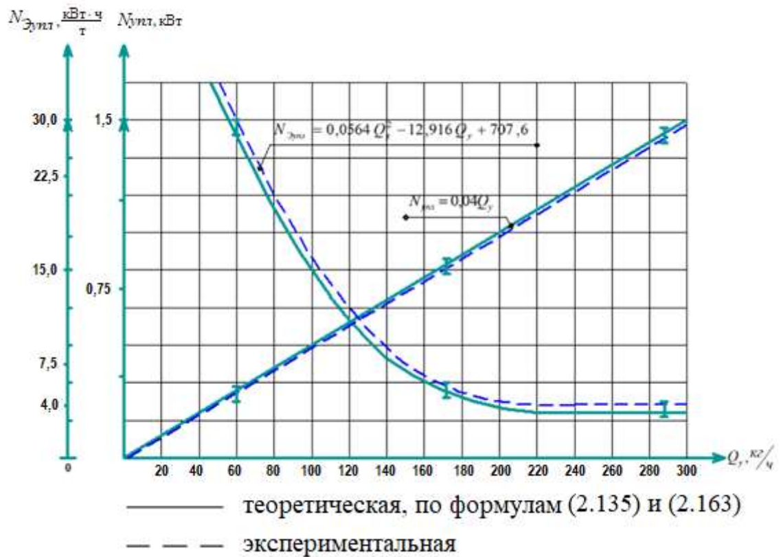
Рисунок 3.33 – Зависимости мощности, затрачиваемой на прессование N_{у\text{пл}} и энергоёмкости от производительности пресса Q_{у\text{пл}} .
