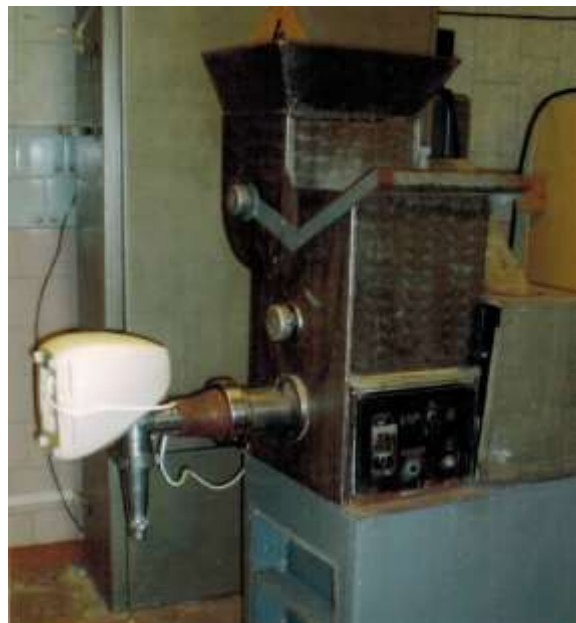
Рисунок 30П – Общий вид пресса с различной компоновкой прессующе-формующего узла
