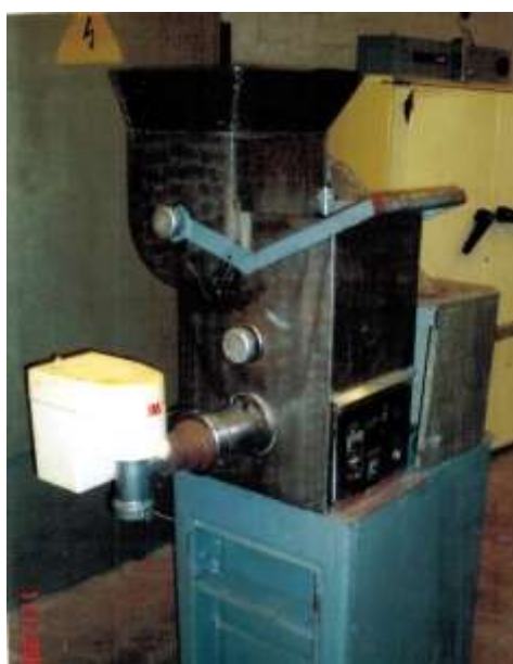
Рисунок 27П – Общий вид пресса с компрессионной камерой и активным прессующим узлом
