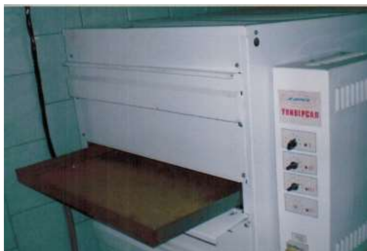
Рисунок 28П – Общий вид сушильного шкафа с сушеным БКД
