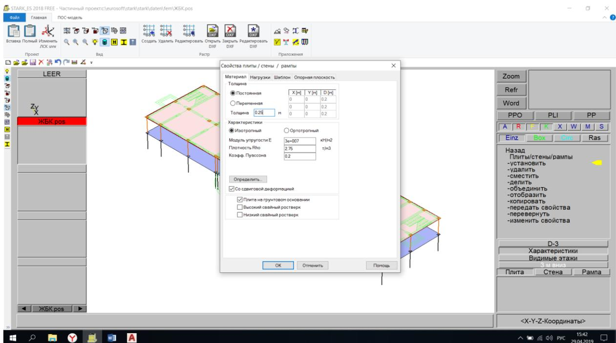
Вкладка «Опорная плоскость» → Координата Z=0 (она должна соответствовать отметке этажа) → ОК
