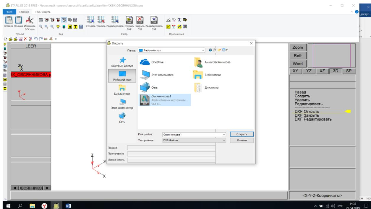
Масштабирование DXF-файла → Перевод размеров из мм в м → ОК
