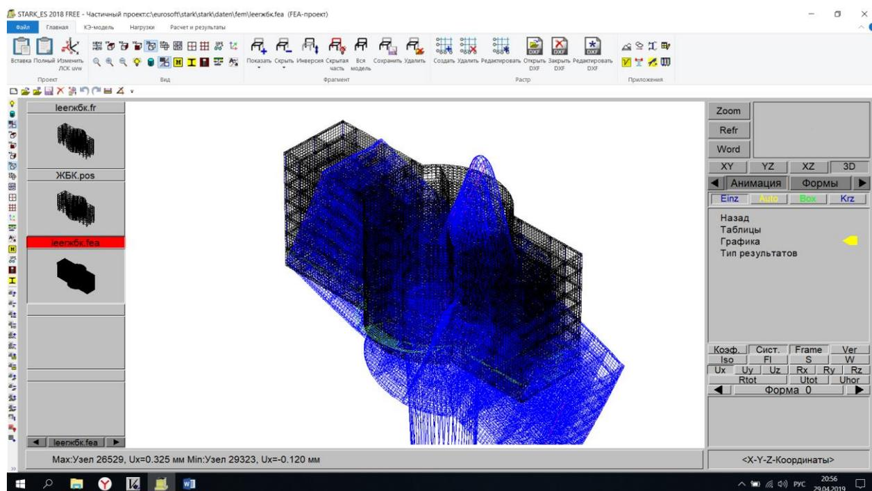
Результатами частотного анализа являются собственные частоты изделия и соответствующие им собственные формы колебаний. Формы колебаний представляют собой относительные амплитуды перемещений конструкции в узлах конечно-элементной сетки. По ним можно определить характер движения, осуществляемого системой на частоте колебаний, соответствующей собственной.
