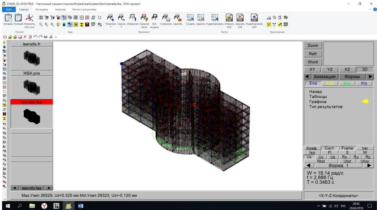
Нажимаем «Формы» → Выбираем одну из собственных форм колебаний → Увеличиваем масштаб → ОК → Нажимаем «Анимация»
