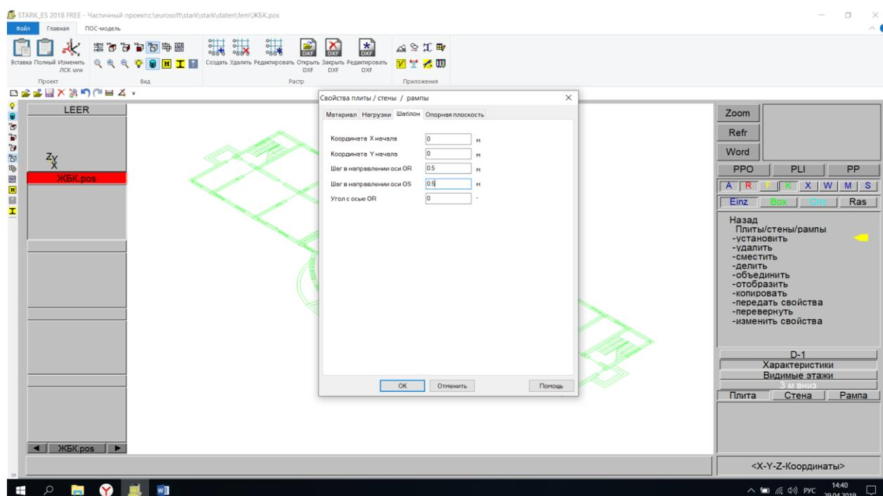
Вкладка «Опорная плоскость» → Координата Z = -3 (она должна соответствовать отметке этажа) → ОК
