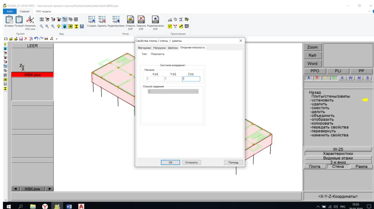
Рисуем стены по контуру фундаментной плиты
