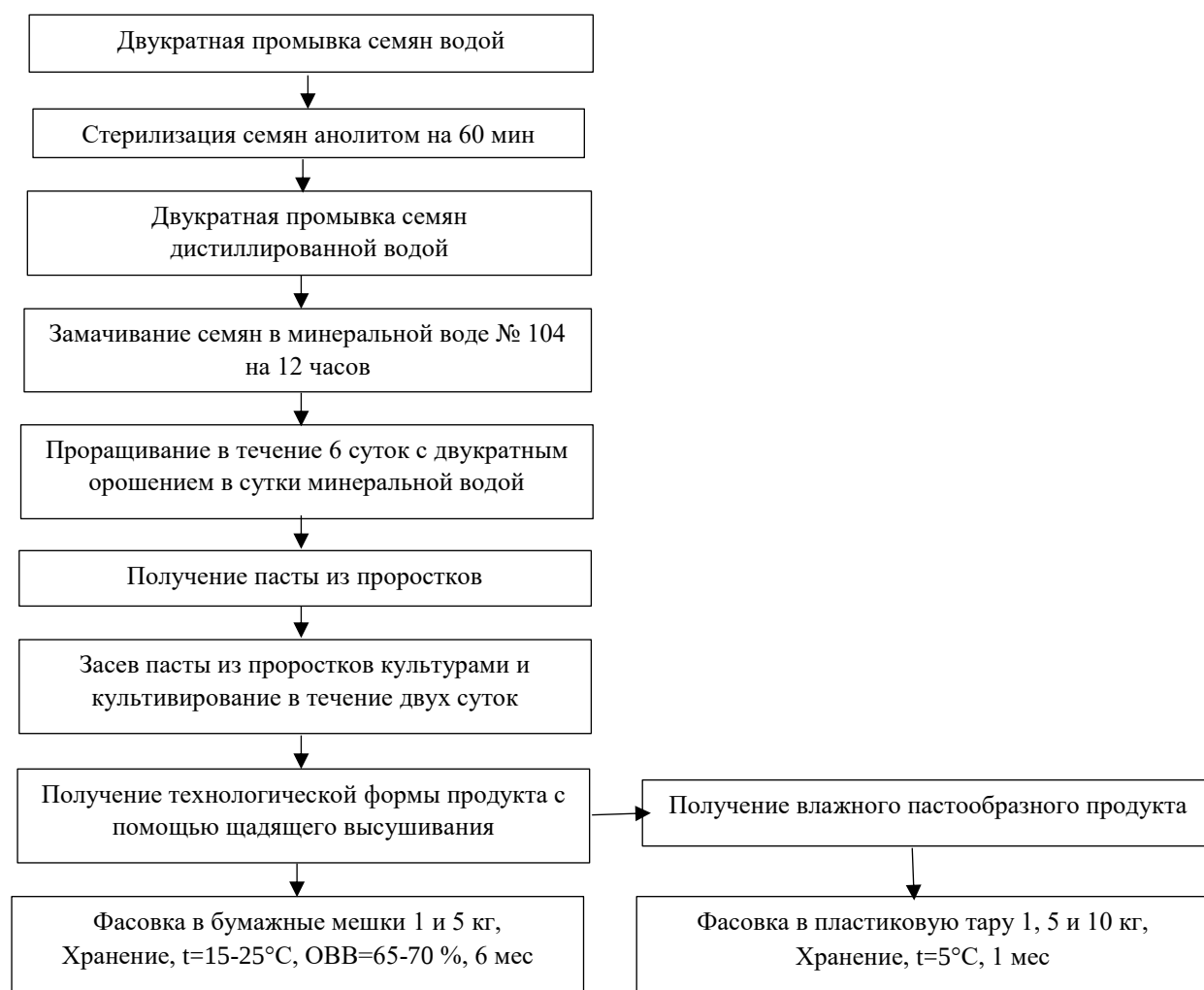
Рисунок 10 – Блок-схема получения кормового биопродукта
