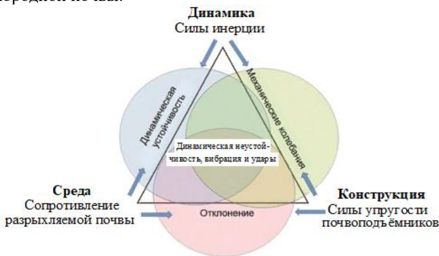
Рисунок 25 – Схема взаимодействия системы сил, действующих на инновационные ломаные почвоподъёмники
