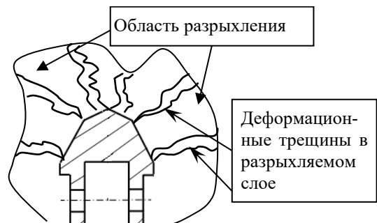
Рисунок 14б – Вид области разрыхления от инновационного наральника
