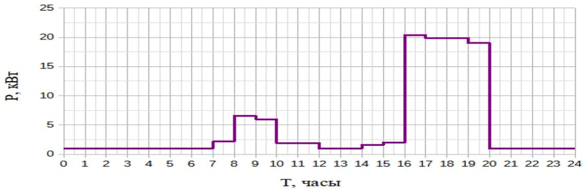
Рисунок 10 – График электрических нагрузок процесса изготовления напитка с учетом мощностей выбранного оборудования
