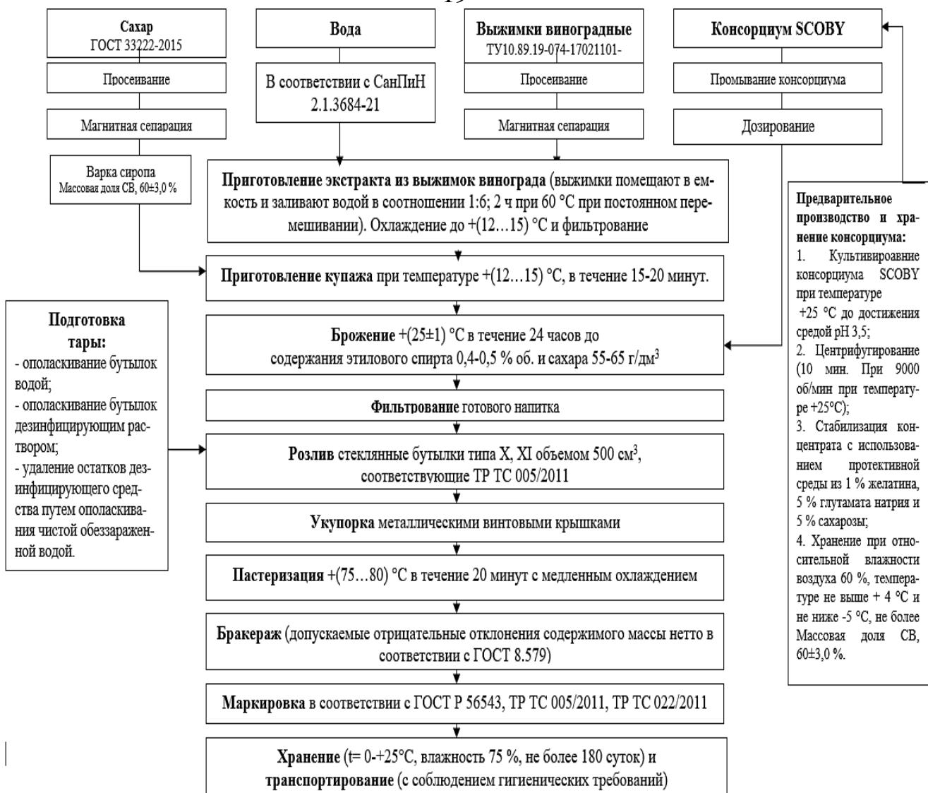
Рисунок 9 – Структурно-функциональная схема производства напитка
