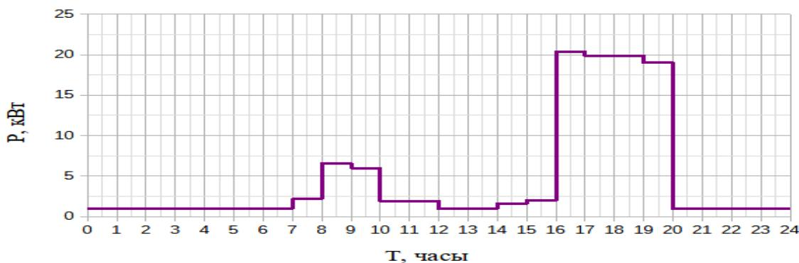
Рисунок 10 – График электрических нагрузок процесса изготовления напитка с учетом мощностей подобранного оборудования
