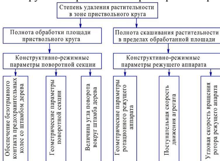
Рисунок 2 – Схема взаимосвязи конструктивно-режимных параметров косилки и степени удаления растительности в зоне приствольного круга
