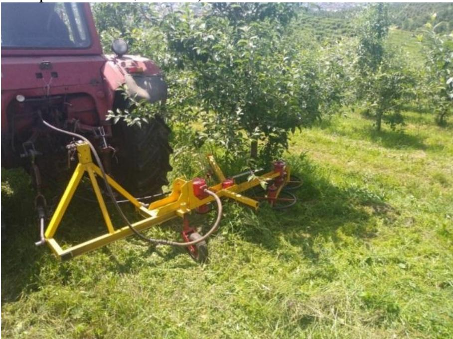
Рисунок 17 – Общий вид экспериментального образца косилки при обработке приствольной полосы
