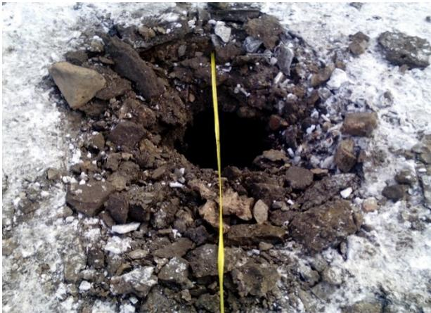
*Определение направления траектории артиллерийского снаряда по внешнему контуру воронки.*
