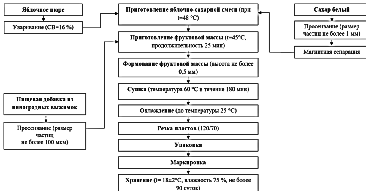
Рисунок 7 – Технологическая схема производства смоквы
