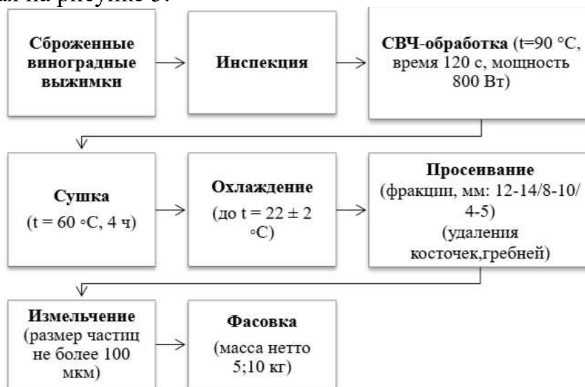
Рисунок 5 – Структурная схема процесса производства пищевой добавки из виноградных выжимок
