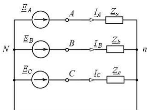
В изображенной схеме с симметричной системой ЭДС  $E_A, E_B, E_C$  соотношение  $U_\phi = \sqrt{3}U_\lambda$  выполняется \_\_\_\_\_ нагрузке (нагрузках).
