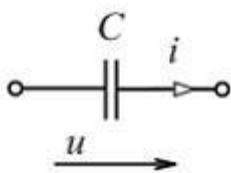
В изображенной схеме угол сдвига фаз между напряжением и током  $i$  равен \_\_\_\_\_ радиан.
