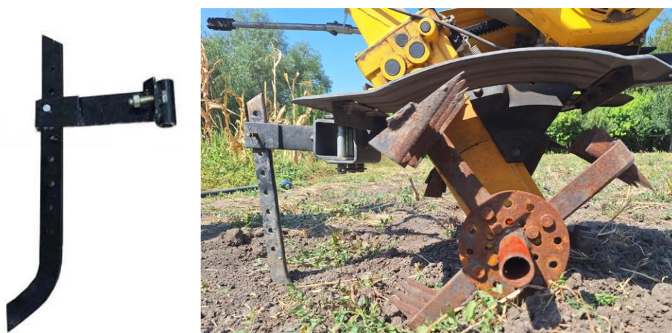
Рисунок 3.3 – Общий вид экспериментальной установки с ограничителем глубины фрезерования почвы
