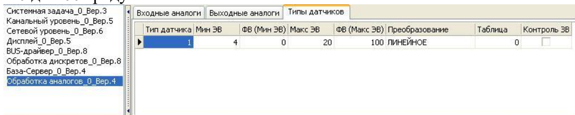
Рисунок 42 – Пример заполнения вкладки «Типы датчиков».
