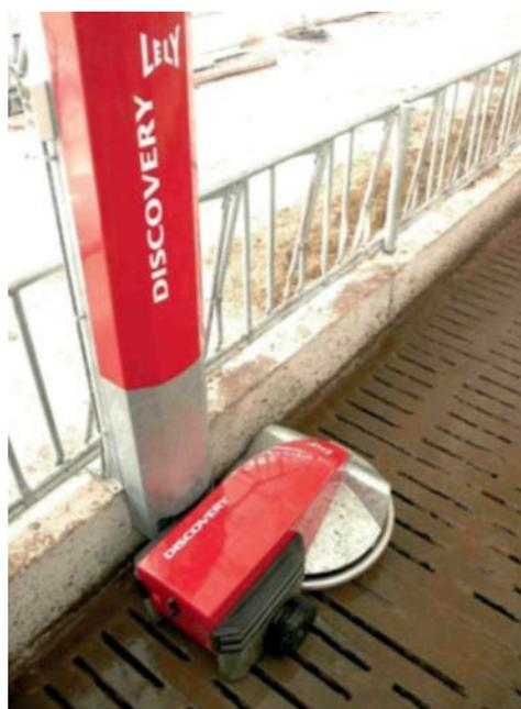
Рисунок 8.17 – Зарядная станция навозоуборочного робота *Discovery*
