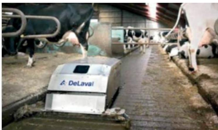
Рисунок 8.13 – Навозоуборочный робот RS250 фирмы DeLaval
