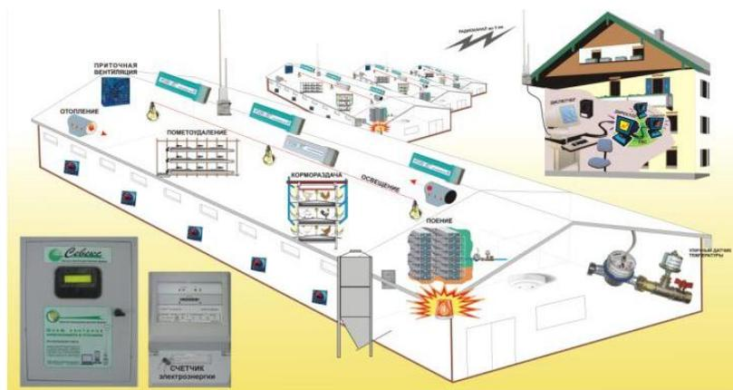
Рисунок 8.9 – Система диспетчеризации птицефабрик НПФ «Севекс»
