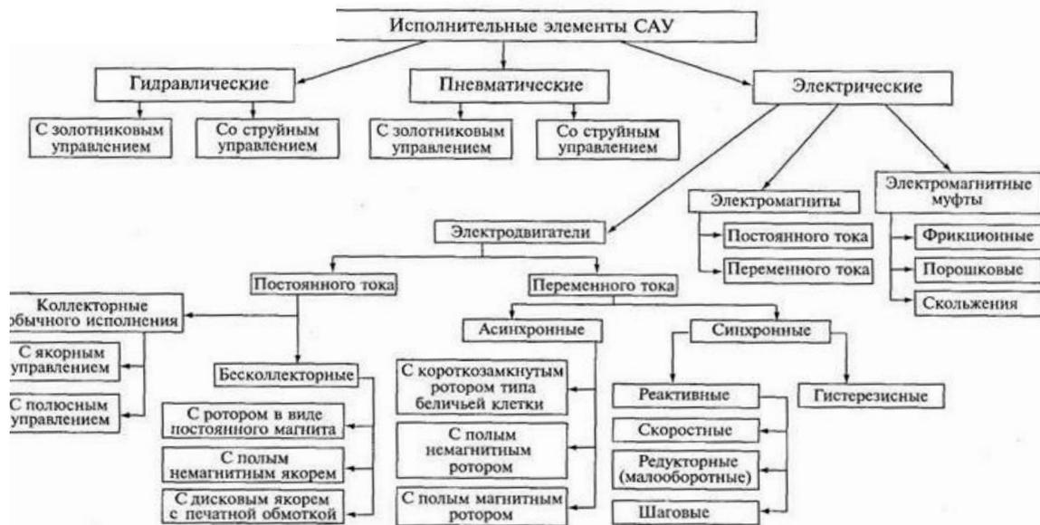
Рисунок 2.6 – Классификация исполнительных элементов системы
