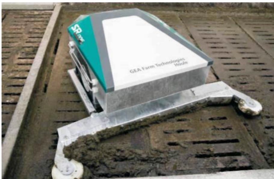
Рисунок 8.12 – Навозоуборочный робот *Srone*
