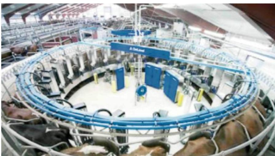
Рисунок 6.13 – Автоматизированная доильная карусель *DeLaval AMR™*
