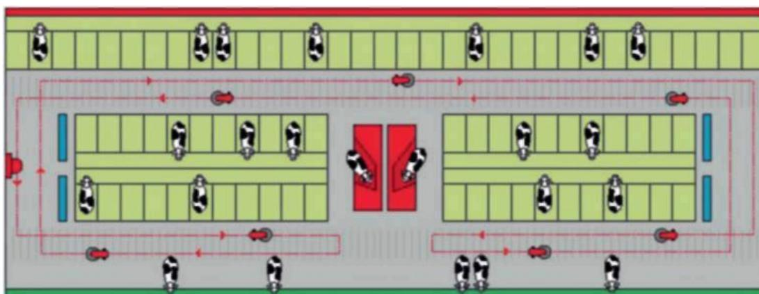
Рисунок 8.16 – Один из вариантов маршрута движения навозоуборочного робота *Discovery*
