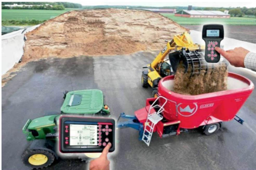
Рисунок 6.18 – Беспроводной терминал SILOKING Wireless
