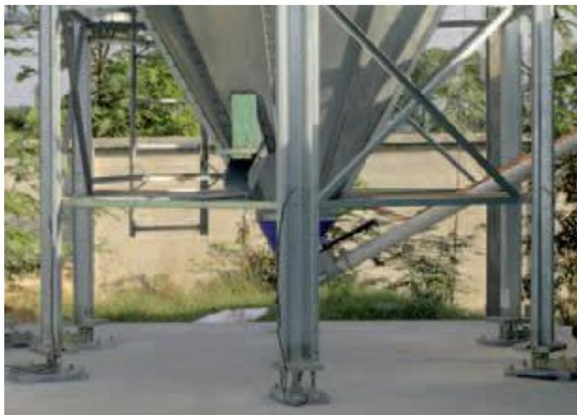
Рисунок 7.5 – Взвешивание бункера электронными тензодатчиками
