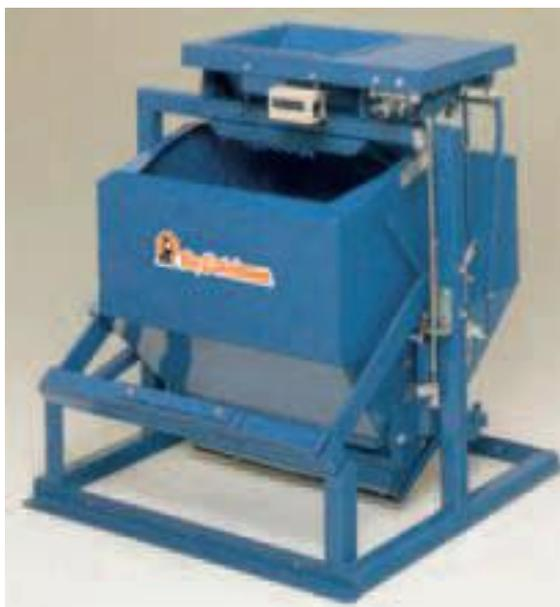
Рисунок 7.4 – Механические саморазгружающиеся весы
