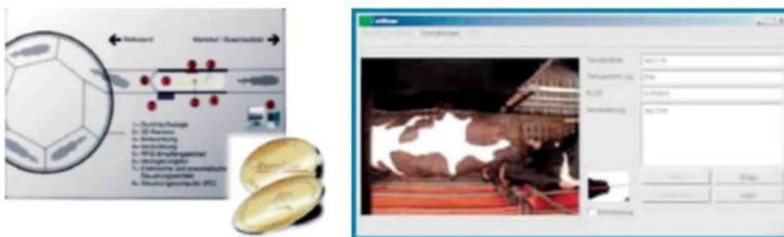
Рисунок 6.8 – Схема работы прибора *optiCOW* для измерения и взвешивания коров
