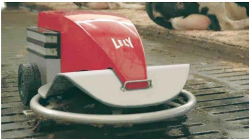
Рисунок 8.15 – Навозоуборочный робот *Discovery*
