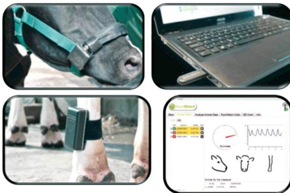
Рисунок 6.7 – Система мониторинга состояния здоровья жвачных животных
