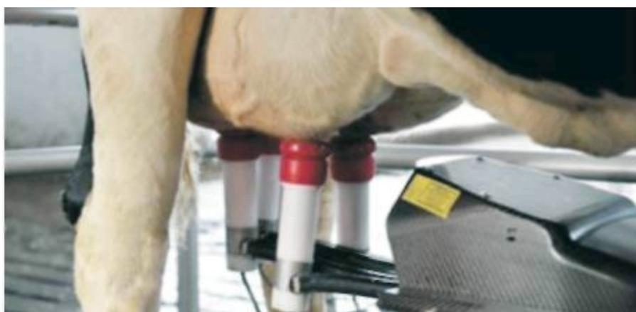
Рисунок 6.11 – Рука-манипулятор после установки доильных стаканов остается под выменем животного
