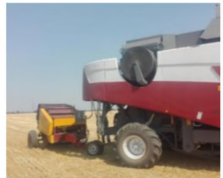
Рисунок 8 – Составляющие синтеза МФА для уборки зерна с прессованием соломы
