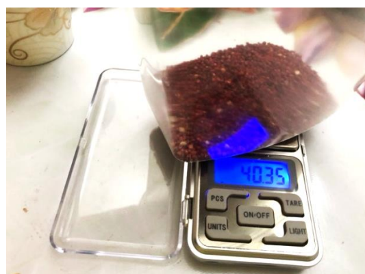
Рисунок 3.11. – Фото взвешивания контрольного компонента, отобранного из пробы
