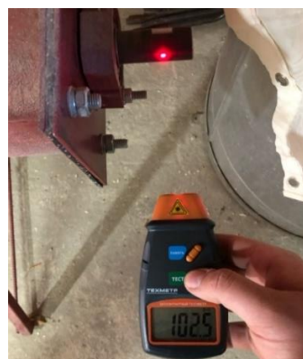
Рисунок 3.7. – Фото процесса замера частоты вращения вала смесителя
