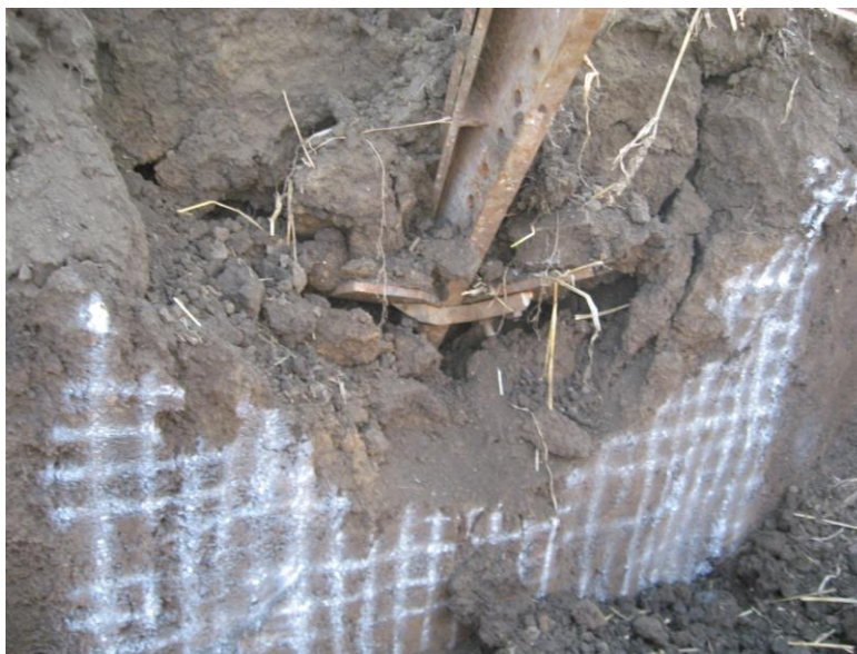
Рисунок 6.12 – Вид области разрыхления – опыт № 2
