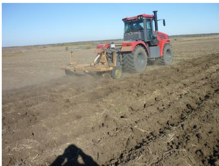
Рисунок 6.27 – Разрыхление базовой компоновкой ГСЗ
