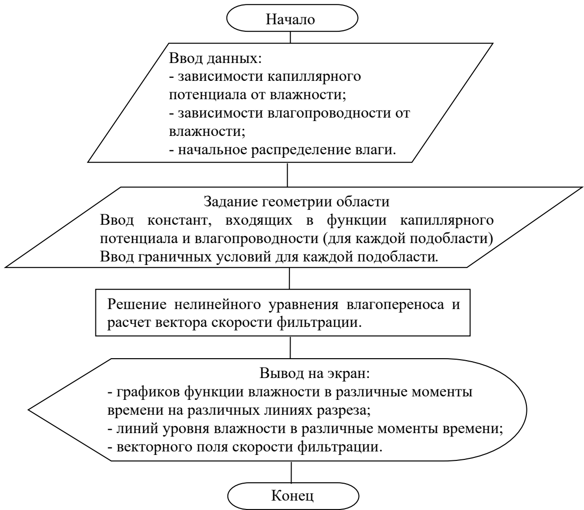
Рисунок 4.4 – Блок-схема алгоритма решения задачи влагопереноса
