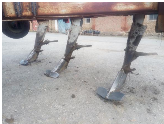
Рисунок 6.28 – Общий вид стоек с нижним расположением пчвоподъёмников
