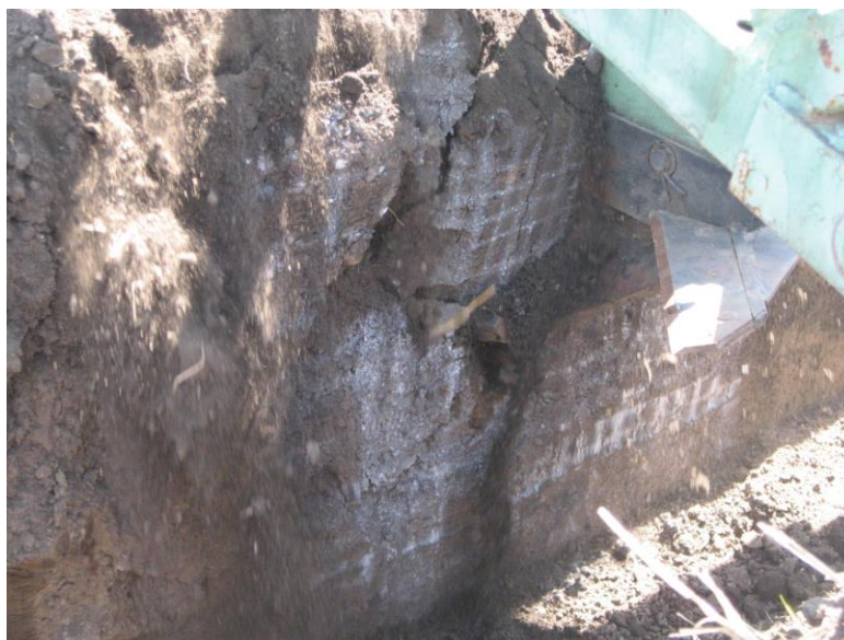
Рисунок 6.21 – Вид пенетрации стойки рыхлителя – УНС-5
