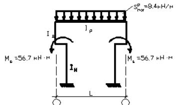
Рис.2.3 – Расчетная схема рамы от действия снеговой нагрузки (нагружение № 2)
