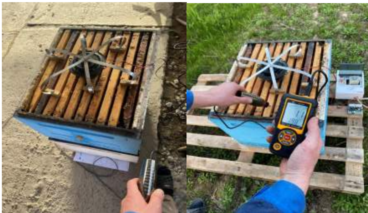
Рисунок 3.3 – Внешний вид улья с установленным вибратором и использование виброметра
