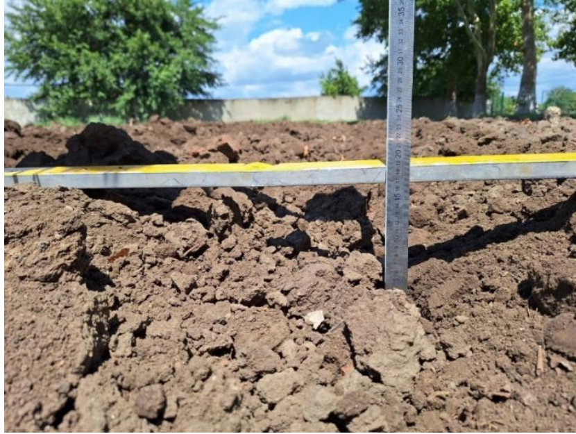
Рисунок 3.15 – Определение равномерности глубины обработки и глыбистости
