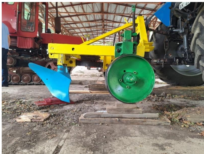
Рисунок 3.4 – Регулировка глубины обработки рабочим органом
