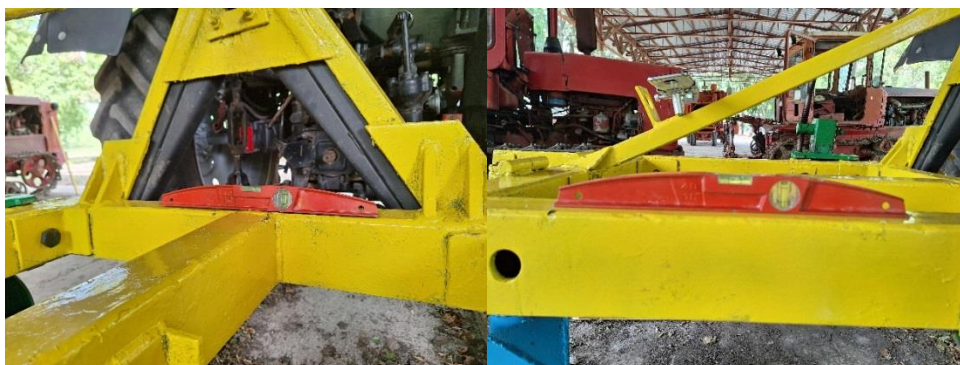
Рисунок 3.5 – Регулировка перекоса навески.
