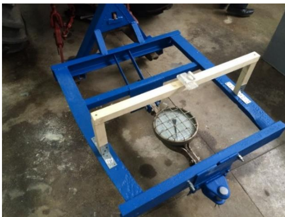
Рисунок 3.4 – Общий вид экспериментальной установки для динамометрирования пресс-подборщика ПРФ-180
