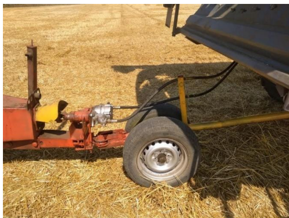
Рисунок 3.2 – Сцепка к комбайну TORUM-740 для агрегатирования пресс-подборщика ПРФ-180
