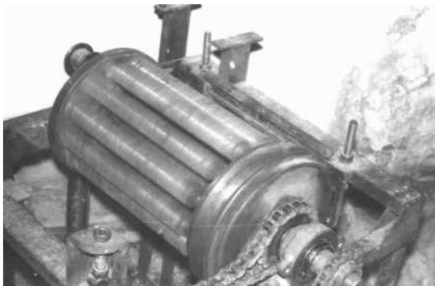
Рисунок 1.7 – Общий вид экспериментальной установки для проверки способа обмолота кукурузы по патенту РФ № 2190316 [45]
