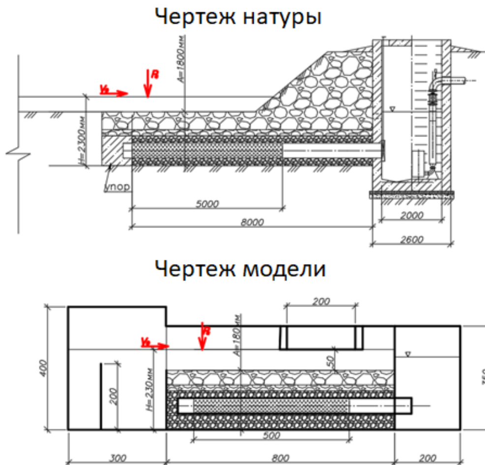
Рисунок 4.2 – Основные геометрические размеры фильтрующего водозаборного сооружения натуры и модели
