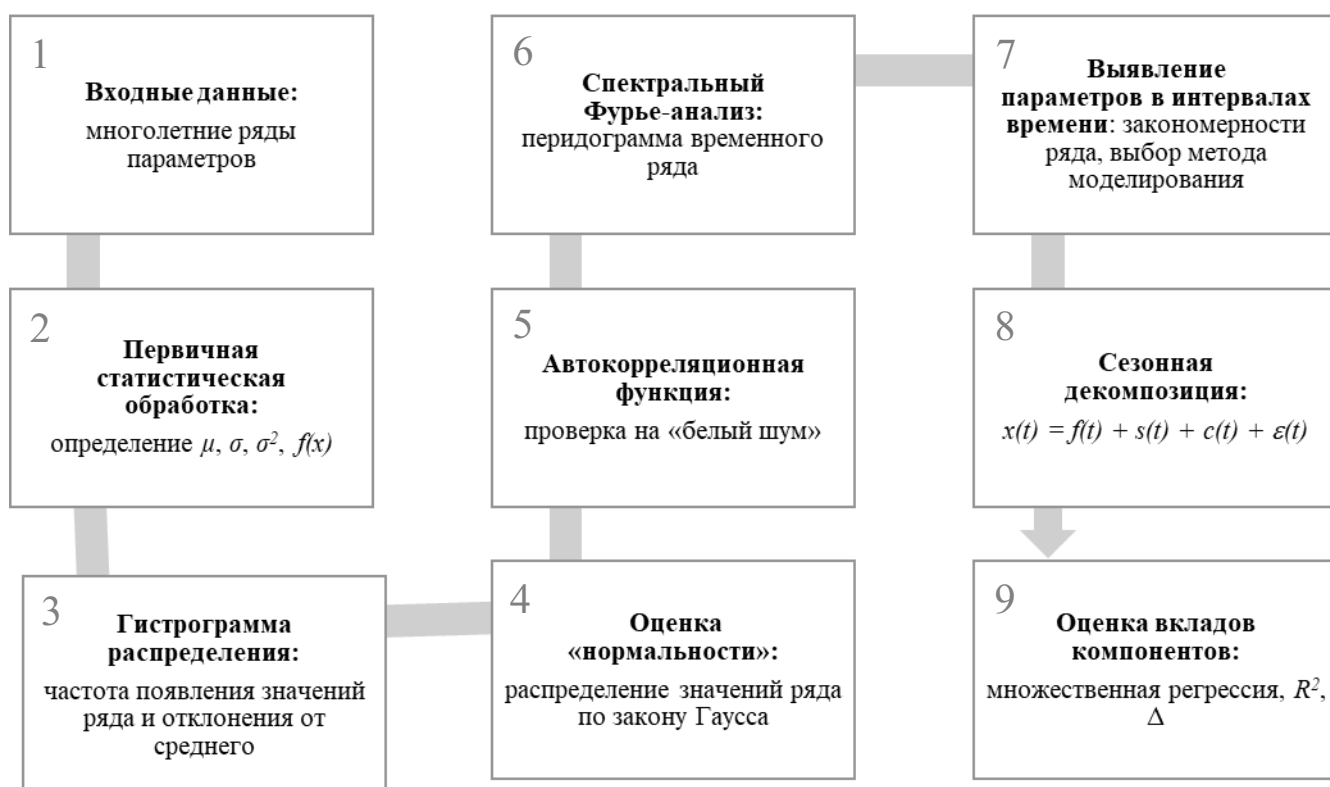
Рисунок 3.12 – Блок-схема математического моделирования метеорядов
