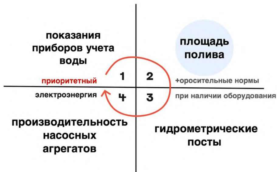
Рисунок 2.2 – Схема способов определения объёмов оросительной воды
