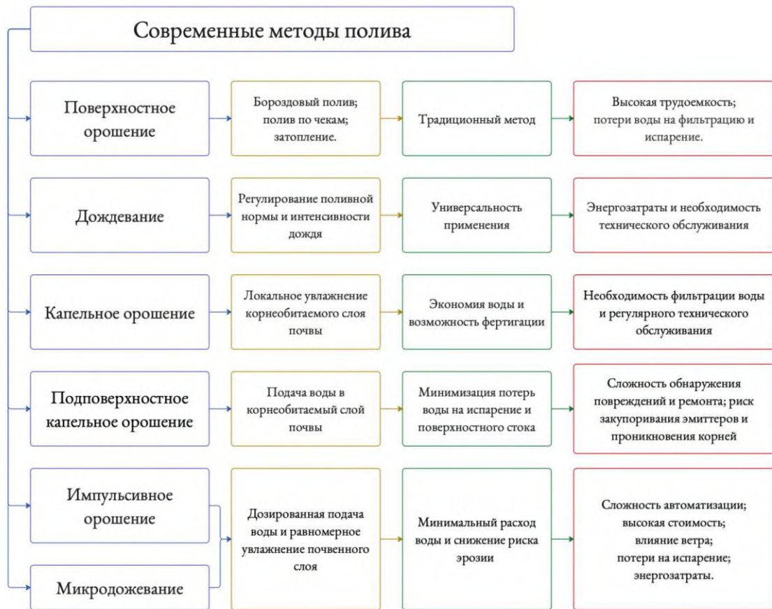
Рисунок 2.10 – Схема классификации современных методов орошения
