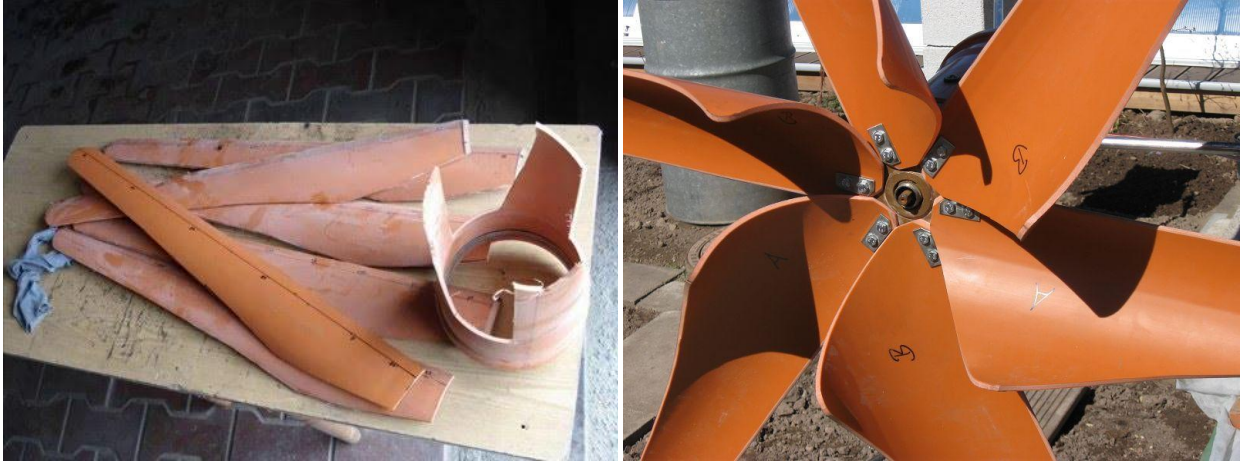
Рисунок 1.10 – Самодельные лопасти из пластика для горизонтально-осевой ВЭУ
