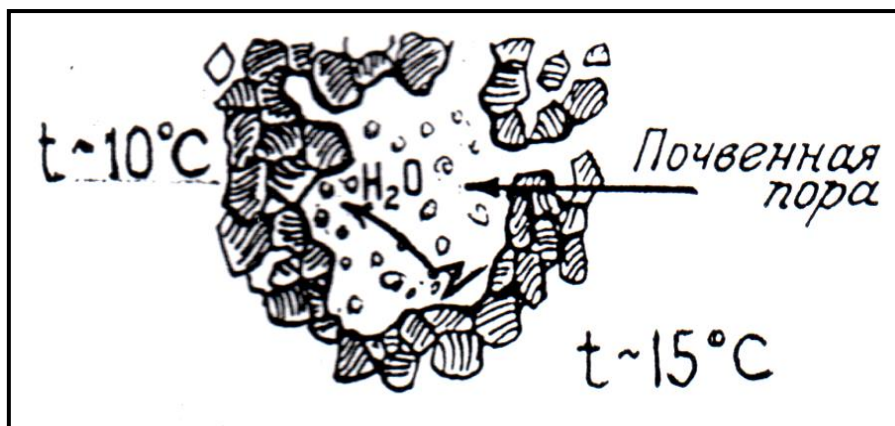
Рисунок 30 – Движение и направление движения пара внутри почвенной поры от теплого участка поры к холодному при относительной влажности всего порового пространства ~ 100 %
