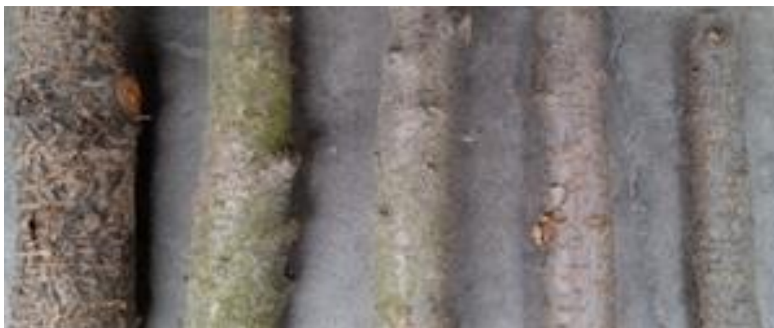
Рисунок 3.4 – Экспериментальные поленья, имитирующие штамб
