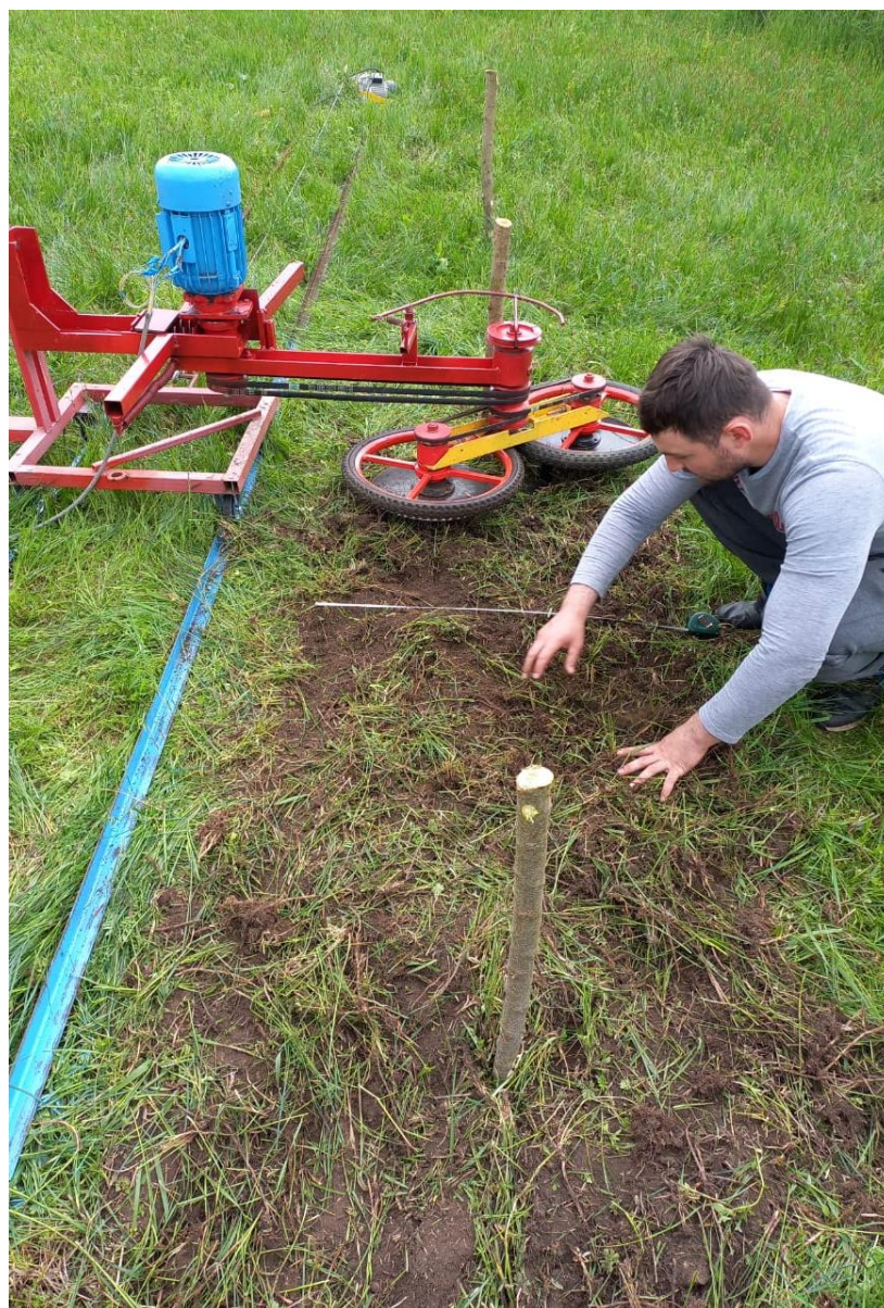
Рисунок 3.6 - Контроль качества фрезерования почвы вокруг штамба
