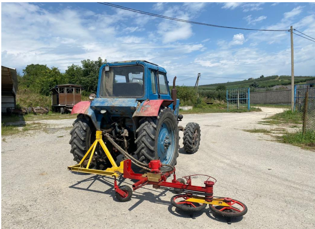
Рисунок 3.11 – Опытный образец двухроторной фрезы
