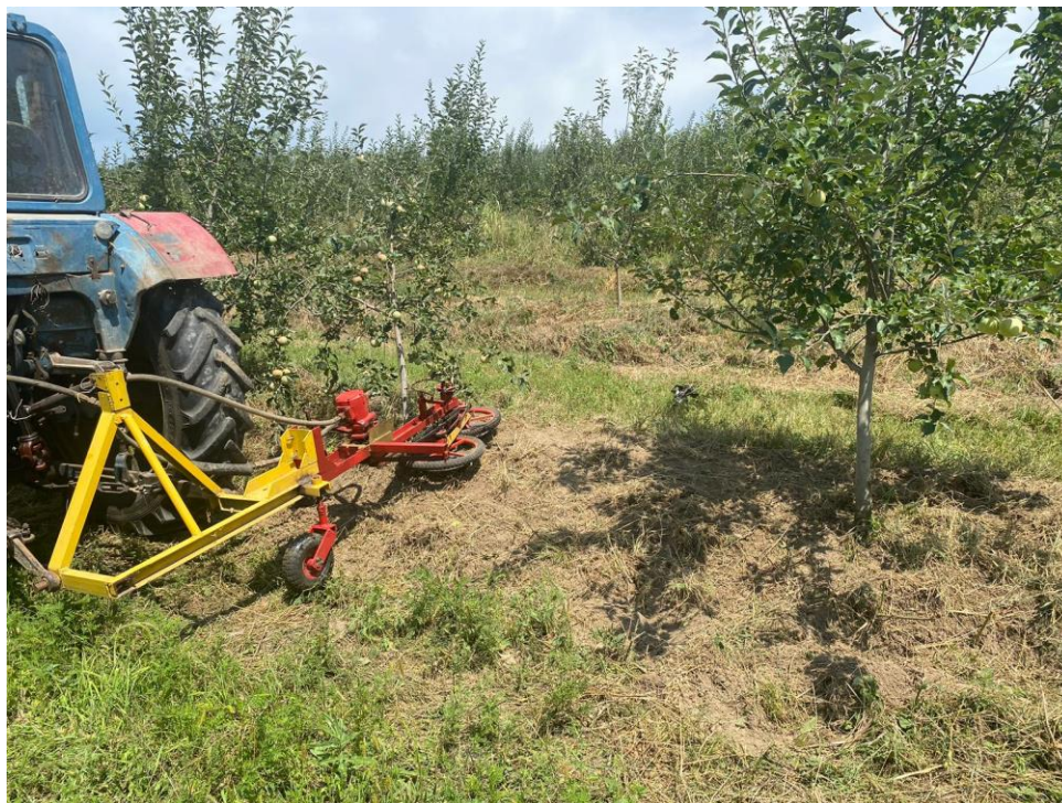
Рисунок 3.12 – Производственные испытания двухроторной садовой фрезы
