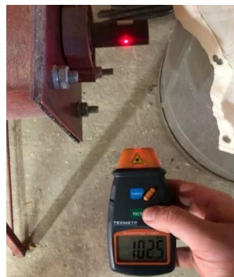
Рисунок 3.7. – Фото процесса замера частоты вращения вала смесителя
