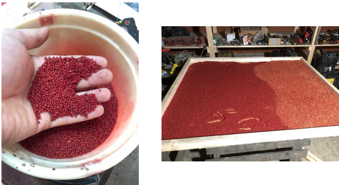
Рисунок 3.5. – Общий вид контрольного компонента (подкрашенная пищевым красителем пшенная крупа)
