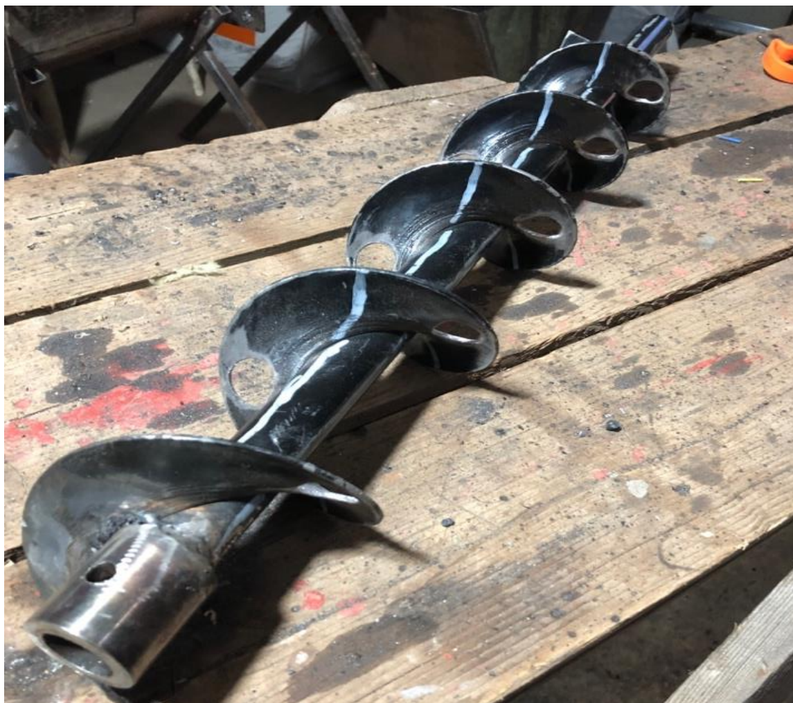
Рисунок 3.2. – Общий вид шнековой мешалки с пересыпными отверстиями
