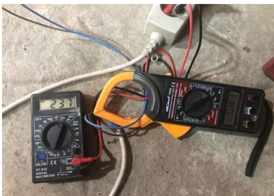
Рисунок 3.6. – Фото процесса снятия значений потребляемого тока электродвигателем и напряжения сети
