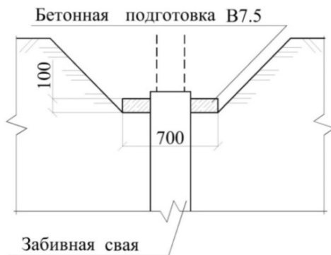
Рисунок 2.12 – Сечение бетонной подготовки 700 мм 2–2
